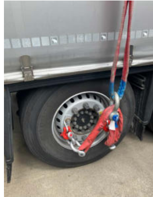
Das Krause System wird an den Radbolzen befestigt und schafft einen schnellen und sicheren Anschlagpunkt zum Heben, Sichern und Ziehen. (© Holtbrügger)
