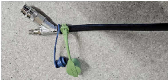
1 Meter Rettungsleitung am M1 MSA Safety
