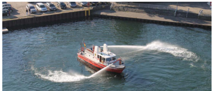
Karussellfahrt beim Übungsdienst, Antrieb des FLB mittels Wasserwerfern beim simulierten Ausfall des Antriebsaggregates
