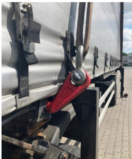
Sogenannte Containerhaken schaffen einen Anschlagpunkt an Containern oder Wechselbrücken. (© Siekaup)
