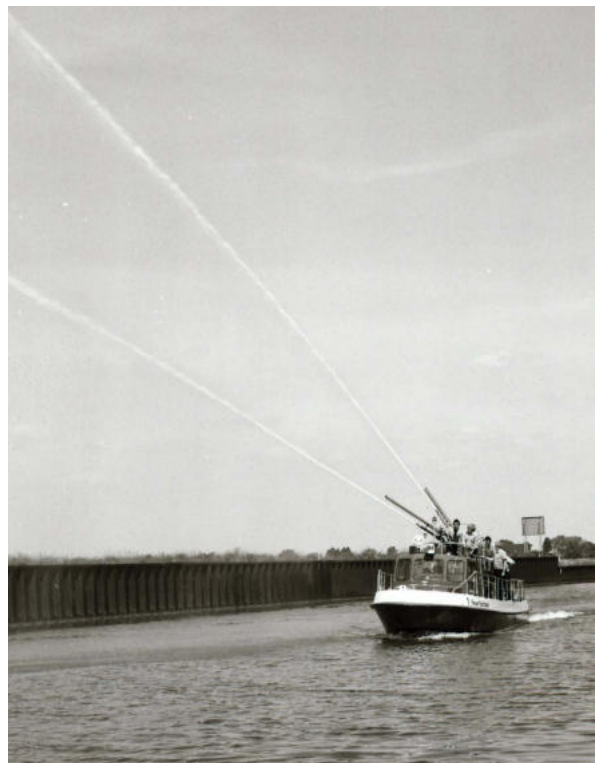
Nach der Havarie ist das FLB mit eiem 2 Schaum-Wasserwerfer ausgestattet worden
