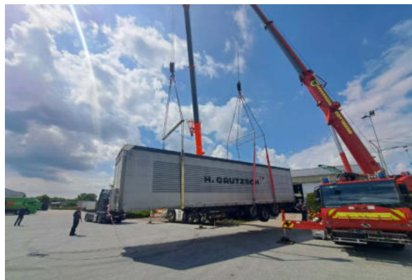
Letzter Akt: Der Sattelaufleger wurde durch beide Kräne angehoben und versetzt. (© Hellmann)
