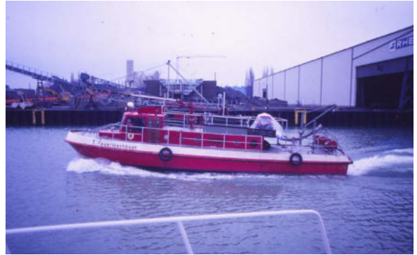
Kurz vor Außerdienststellung ist auf Deck wegen des Defektes der Pumpe an Stelle des 2. Werfers eine TS mit angeschlossener Saugleitung aufgestellt worden
