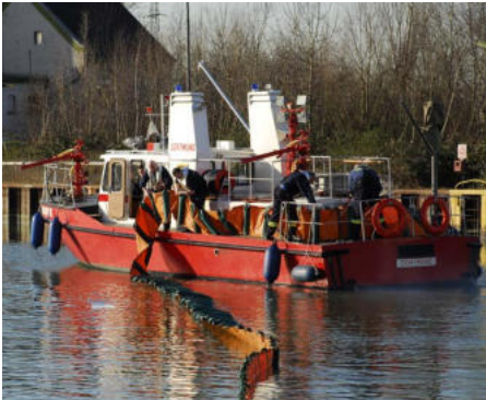
Ausbringen der Ölsperre über das FLB3 im Februar 2008
