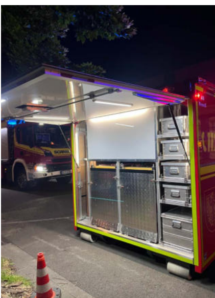
Nützlich: Whiteboard mit Wetterschutz zur Einsatzplanung bei durchdachtem Lichtkonzept (© Holtbrügger)
