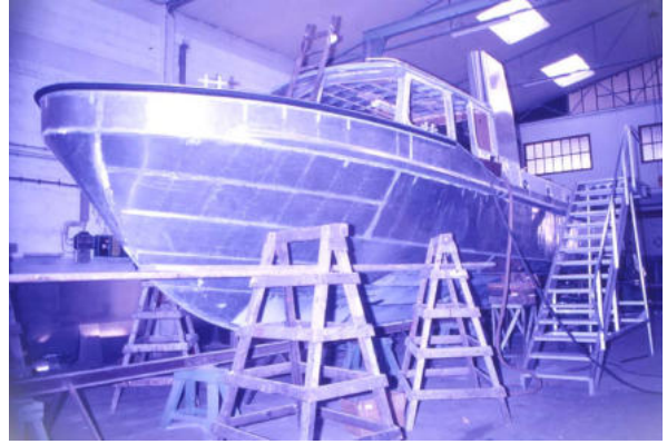
Rohbau des FLB3 in der Werkhalle der Schless-Werft
