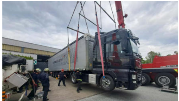
Erst in Waage bringen, dann die Einheiten trennen. Hier war eine gute Planung und genaue Absprache erforderlich (© Demmig)
