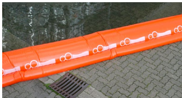
Abb. 2: Der Doppelkammerschlauch als Löschwasserbarriere (Foto: Feuerwehr Dortmund)
